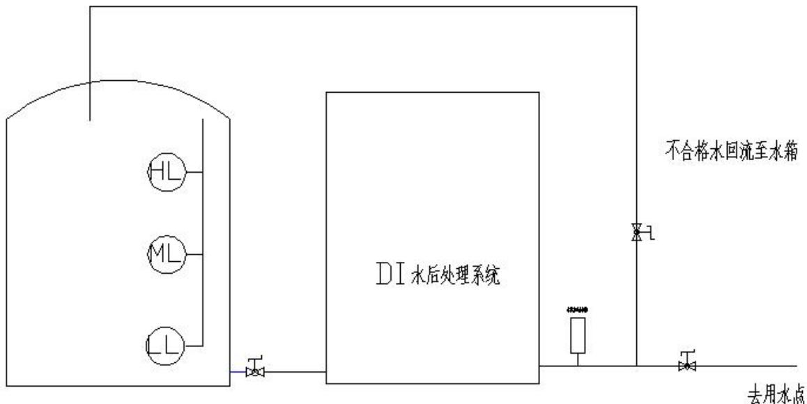
2、系统流程：去离子水——增压泵——UV 紫外线——DI 精滤离子柱——UF 过滤器——合格的去离子水
